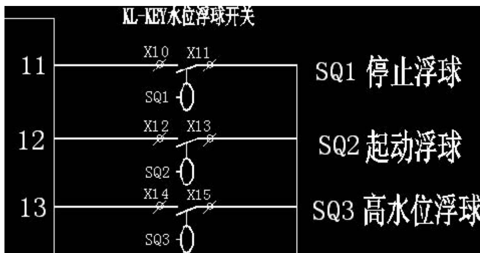
FM2002 控制器 浮球方式控制器接线如上图：
