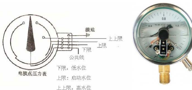
电极点压力表接法
